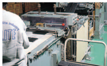
軌道パッドの重量に合わせて裁断
