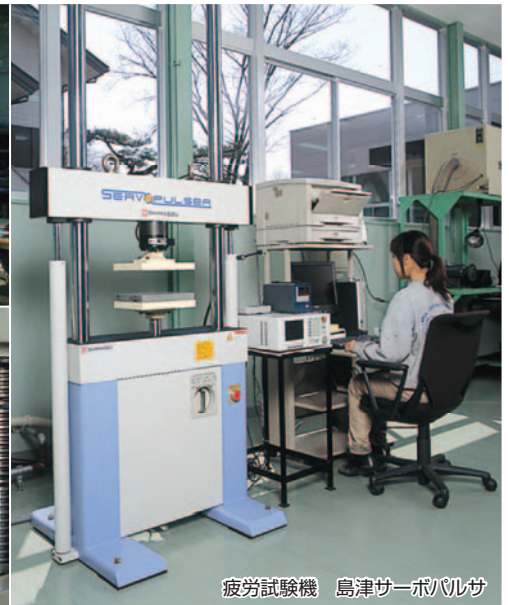
圧縮変形試験
