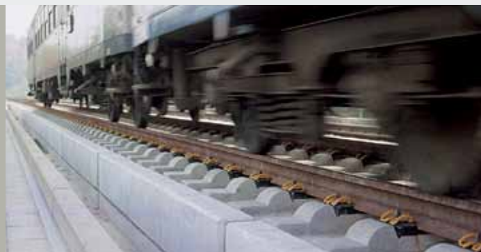
マクラギケース底部敷弾性パッド
