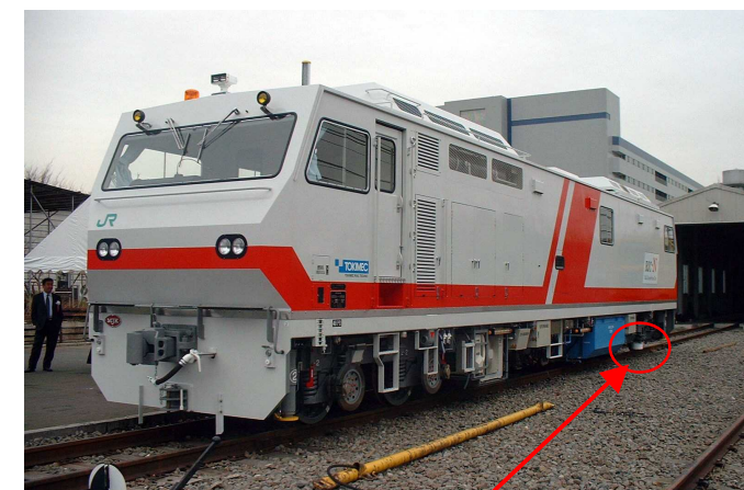
DD車上子: FE-1 超音波レール探傷車の位置情報へ適用
