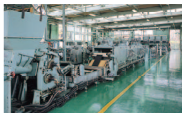
混練～生素地シート製造ライン
