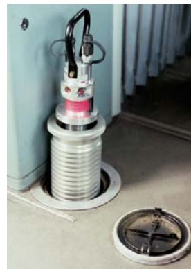
車両に適合した 内部式ジャッキ
