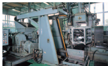
加圧型ニーダーによる混練り作業
