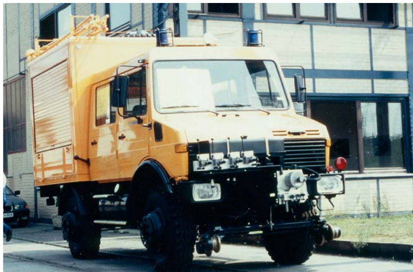
トラックの補助シャフトへの設置用 LUKASバリオセット、パワーユニットと コントロールユニット
