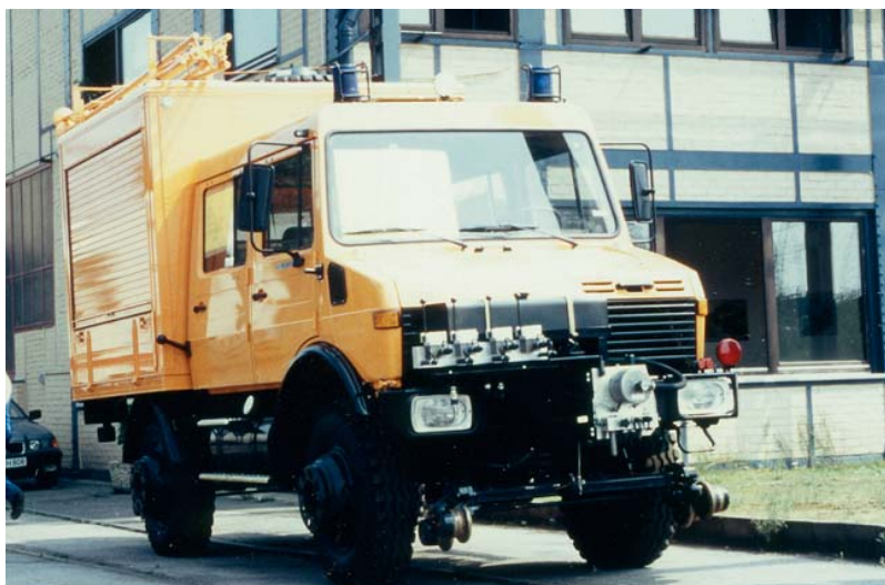
トラックの補助シャフトへの設置用 LUKAS/パリオセット、パワーユニットと コントロールユニット
