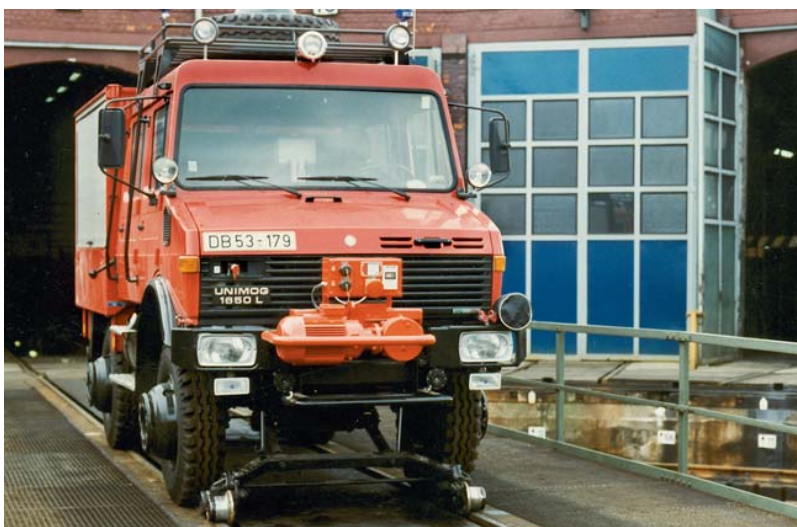
緊急トラック：モーターポンプとコントロ ールデスク付LUKAS脱線復旧システム
