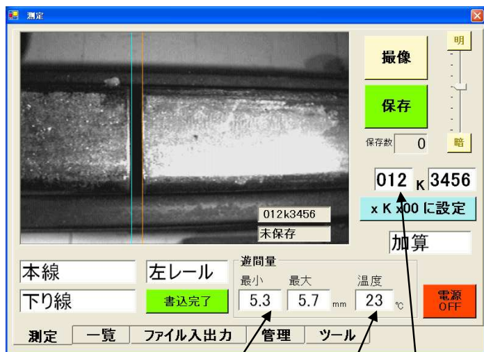
レール遊間量 レール温度 キロ程
