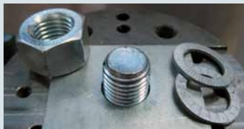
解除した後、ボルト/ナット座面と相手材の両方に、グリップ跡が残っていることを確認してください。
