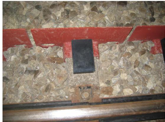
**ボーダン踏切(改良型)**は施工時間の短縮に特化、外部プレートをまくらぎ上で受ける構造に改良した結果、施工が更に容易になりました。繰り返し使用できるボーダン踏切の特徴と相俟って、**工事用**に最適な踏切材として広く皆様にご使用いただけます。
