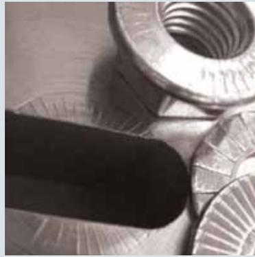
フランジナットとノルトロックSPワッシャーの併用で、長穴の場合の相手材の面圧が大きくなります。
