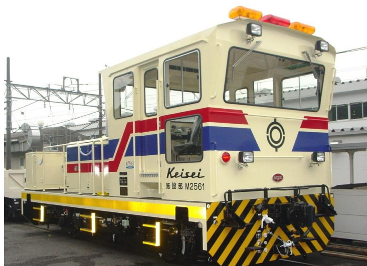
松山重車輛工業製 25t モーターカー M2561 全長：8,250 mm、全幅：2,760 mm、全高：3,820 mm、重量：25t
