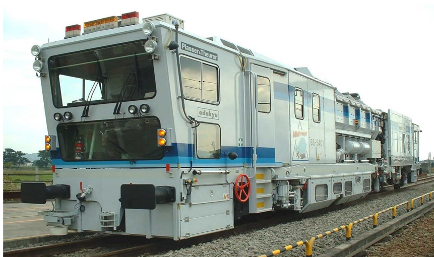
プラーサー&トイラー製バラストスイーパー SIM-22
