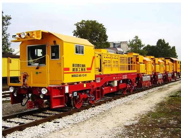
レール削正車 SRR16M2
