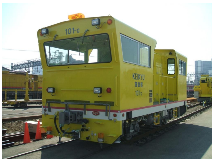
松山重車輛工業製 軌道モーターカー（前後運転室型） 101 - C 全長：8,450 mm、全幅：2,784 mm、全高：3,777 mm、重量：25t
