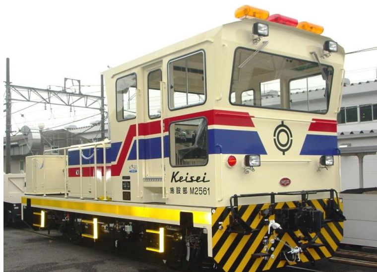
松山重車輛工業製 25t モーターカー M2561 全長：8,250 mm、全幅：2,760 mm、全高：3,820 mm、重量：25t
